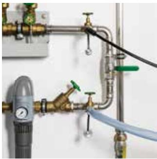
Tlaková skúška a kontrola tesnosti pomocou vody
