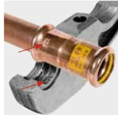
Týmto spätným dosledovaním splňuje REMS doporučenie európskej normy EN 1775:2007 pri inštalácii systémov s lisovanými tvarovkami na plyn.
